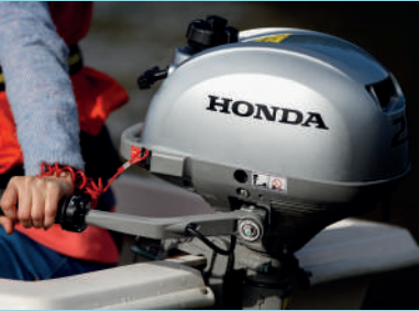
Η εξωλέμβια BF2.3 προσφέρει σύστημα διεύθυνσης 360 ° για απλουστευμένη ικανότητα ελιγμών.
